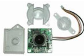
La caméra peut être intégrée dans n'importe quel module de base Vario. Dans le cas d'une faible luminosité, la caméra bascule automatiquement en mode monochrome. Lumière infrarouge supplémentaire. Inclinaison horizontale/verticale en option.
