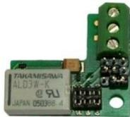
**Contacteur supplémentaire 2N** Kit de montage pour module de base analogique 2N, 2<sup>ème</sup> relais (contact sans potentiel)
