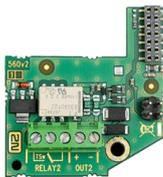
**2N IP Force/Safety 2. Relè** - contatto di commutazione aggiuntivo da installare in 2N IP Force/Safety
