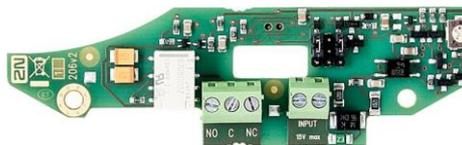
**Interrupteur supplémentaire avec sortie de relais**
