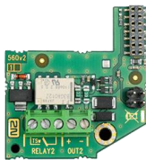
2N IP Force/Safety 2. Relais Zusatzschaltkontakt zum Einbau in 2N IP Force/Safety
