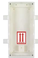
Boîtier d'encastrement 2 modules Forage min. 108 x 238 x 45 mm
